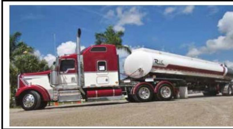
El camión que ven en la fotografía es un camión especial, llamado camión cisterna. En este tipo de camiones se transporta la leche, porque permite conservarla a una temperatura que no excede los 4 °C y así no pierde su calidad.
